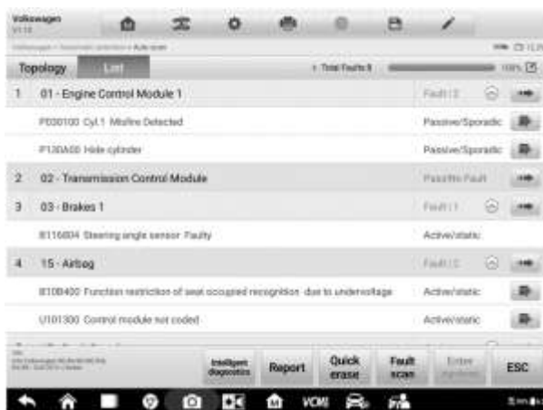
Рисунок 5-7. Пример окна списка систем, сканируемых с целью выявления неисправностей
