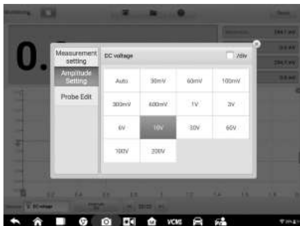
Рисунок 7-17. Окно настройки амплитуды (постоянное напряжение 10 В)
