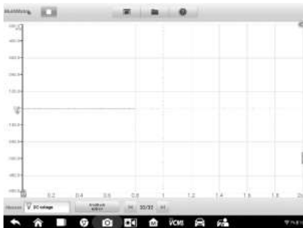
Рисунок 7-11. Пример окна нулевой базовой линии
