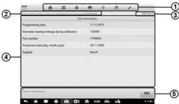
Рисунок 4-15. Пример окна, содержащего информацию об электронном блоке управления
