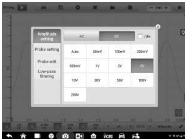
Рисунок 7-49. Пример окна настройки амплитуды (постоянное напряжение 5 В)
