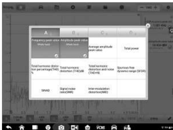
Рисунок 7-85. Пример окна настройки измерений (спектральное представление)
